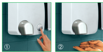
① Ручная сушилка для рук Metal Dry включается нажатием кнопки. Продолжительность подачи горячего воздуха настраивается в пределах от 20 до 60 секунд с помощью установленного в корпусе регулятора
