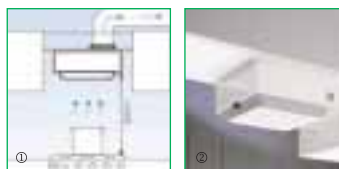
① Установка над кухонной плитой (минимальное расстояние от нагревательной поверхности – 80 см)
